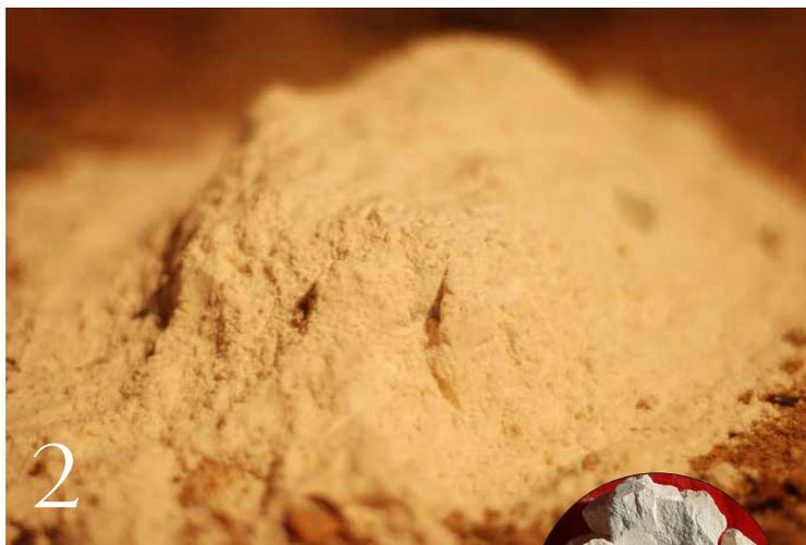
2. 将 3 份生石灰放入坑内，倒入清水没过石灰石。要注意！此时石灰遇水会产生超过 100℃ 的高温，可以直接烫伤皮肤。一定要按照此步骤操作。千万不要先将石灰与沙混合后再加水，那样做会使石灰反应不均匀，导致烫伤。
