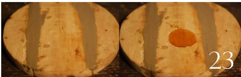
23. 制作桐油石灰膏来填补木桶缝隙。石灰 3 份 + 熟桐油 1 份，和匀，用石锤捣炼成糊状
